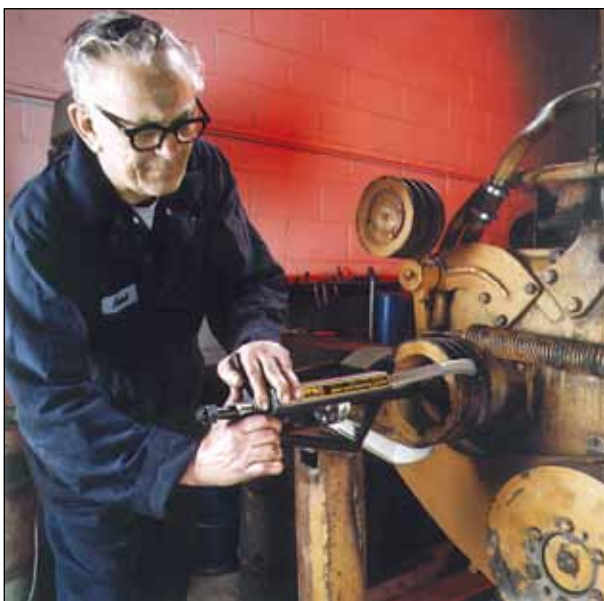
◀ Установка съемника с тремя захватами EP-104 на привод агрегатов дизельного двигателя.
