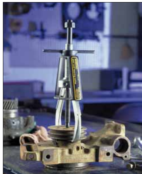
▲ Съемник EP-204 с двумя захватами, установленный для вытаскивания приводного шкива водяного насоса.
